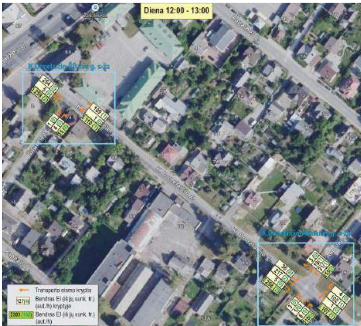
5 pav. Transporto priemonių eismo intensyvumai ir pasiskirstymas K. Donelaičio – Šilutės ir K. Donelaičio - Akmenės gatvių sankryžose. Diena.
