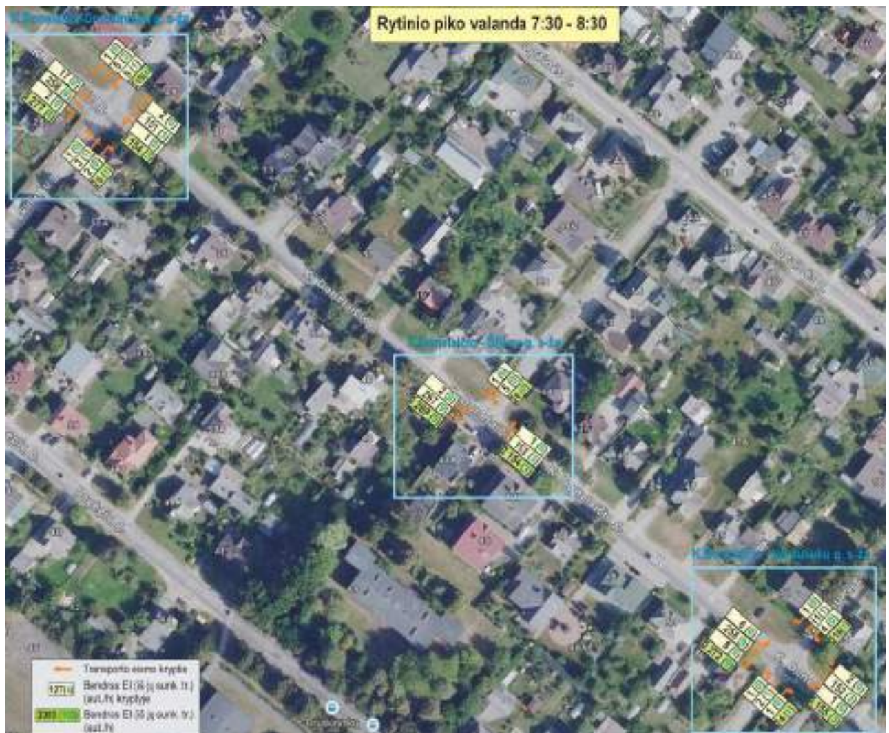
3 pav. Transporto priemonių eismo intensyvumai ir pasiskirstymas K.Donelaičio – Druskininkų, K.Donelaičio - Šilėnų ir K.Donelaičio - Verduliukų gatvių sankryžose. Rytinio piko valanda.
